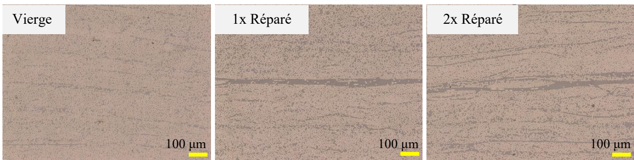
Fig. 1: micro-coupes transverses de trois éprouvettes dans un état vierge et après une ou deux réparations, la zone d'observation se situe au niveau de l'interface de fissuration.
